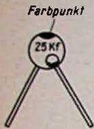
Bild 1. Beispiel für die Kennzeichnung eines Scheibenkondensators
