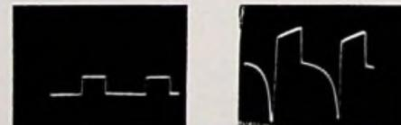
Bild 7. Eine Seite des Kontaktpaares schließt nicht
